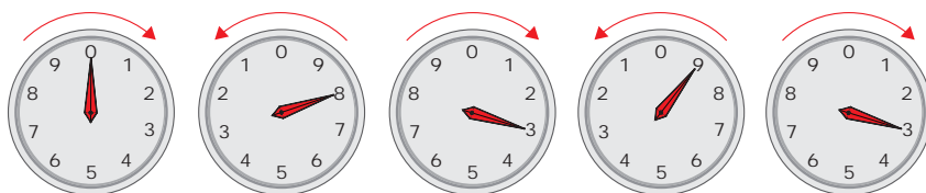
Medidor de energia - Tipo relógio
