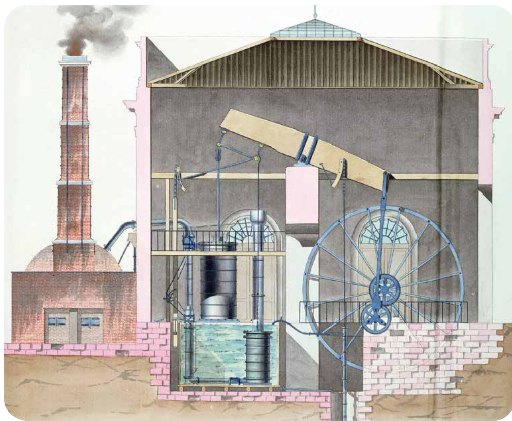
Ilustração do corte de um motor a vapor desenvolvido por James Watt (1736-1819).
