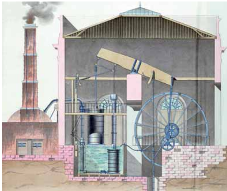
Motor a vapor desenvolvido por James Watt (1736-1819).
