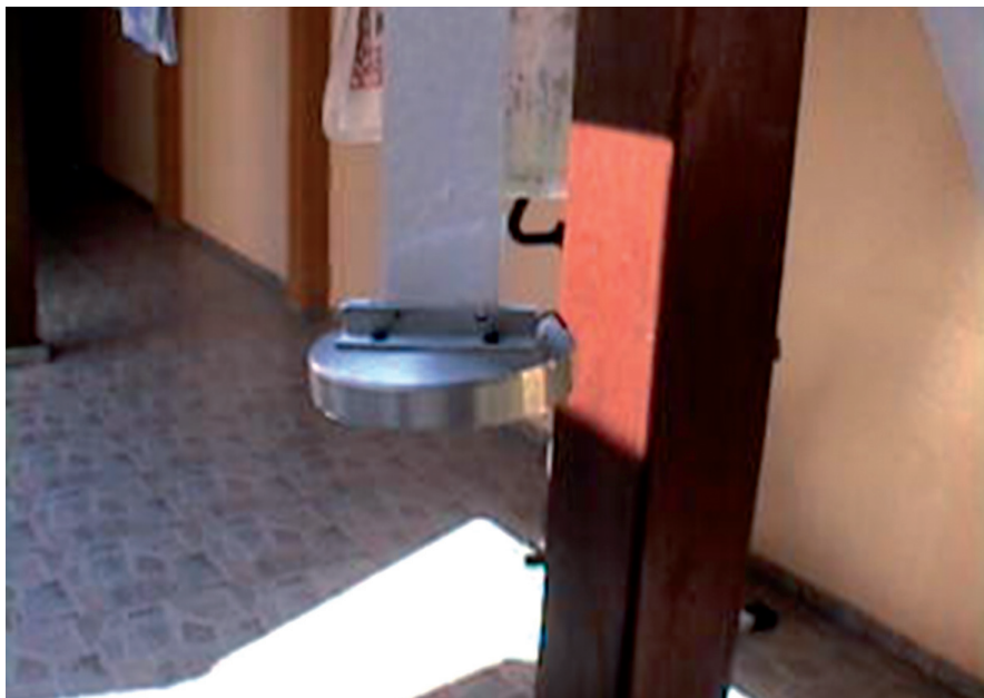
Figura 8 – Tubo de PVC: estrutura para a queda do disco.
