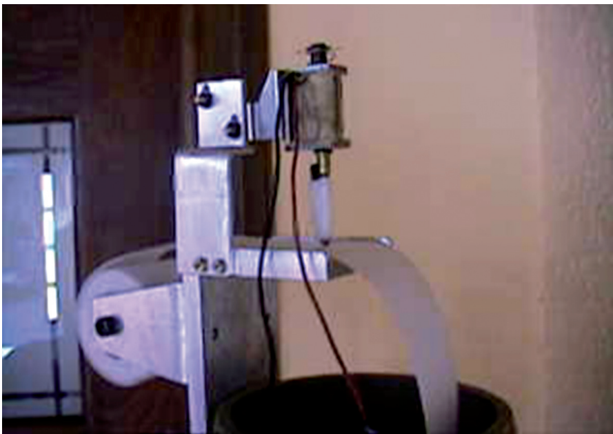
Figura 10 – Fita de papel passando pelo vibrador (marcador de tempo).
