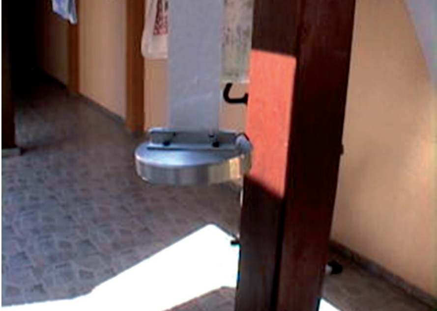
Figura 9 – Fita de papel presa ao disco.
